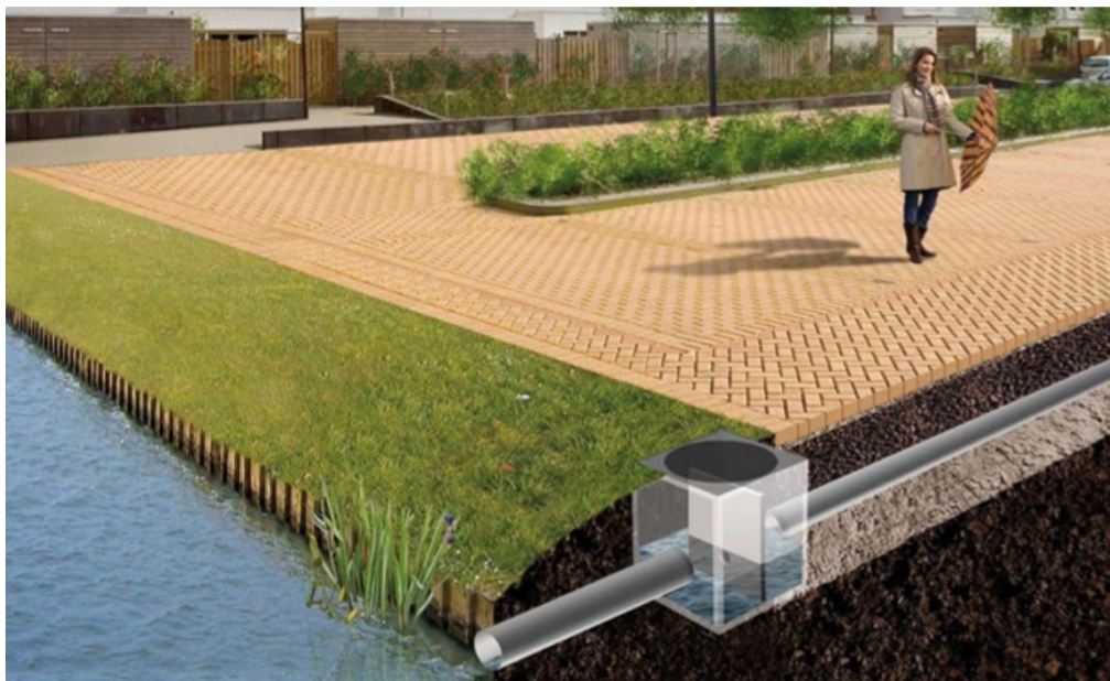
Figuur 4: Voorbeeld waterpasserende bestrating met bergings- en lozingsvoorziening
